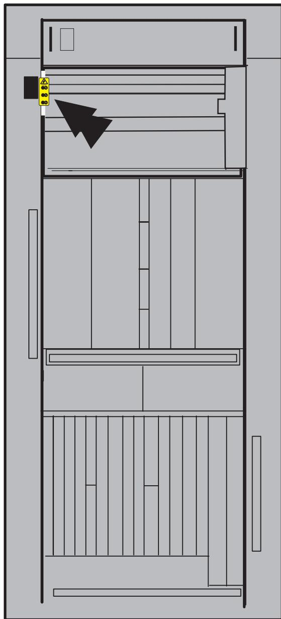
導入済み装置の「>200V」ラベルが正しい場所に、人が読める状態で取り付けられていることを確認します。
