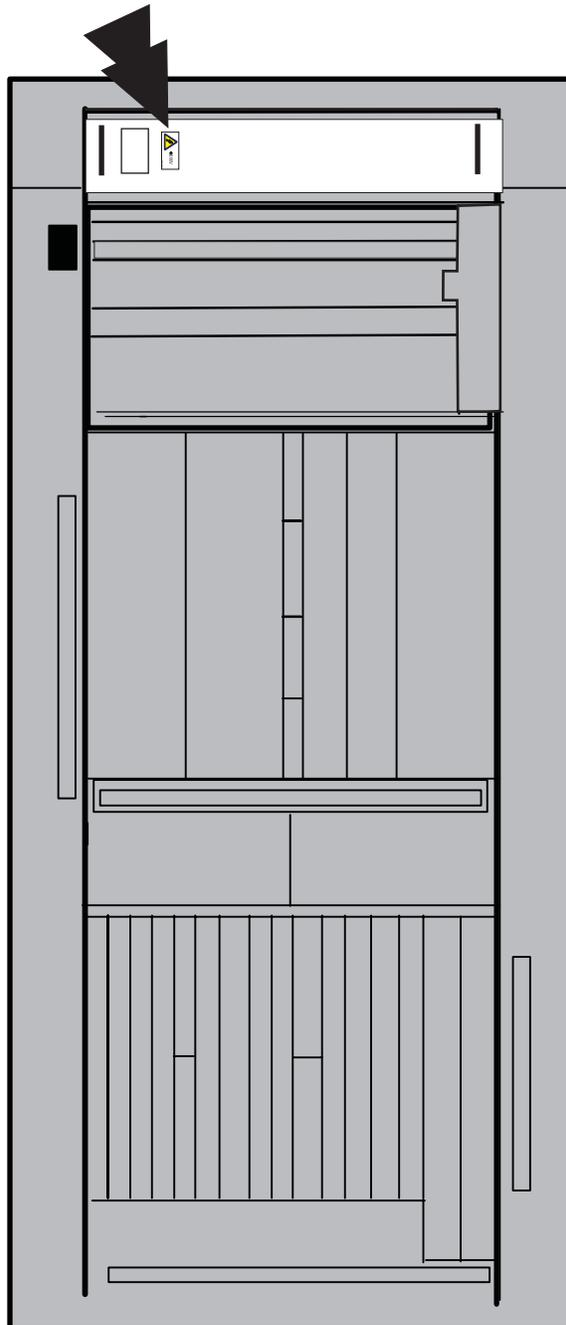
導入済み装置の「>32kg」ラベルが正しい位置に、人が読める状態で取り付けられていることを確認します。
