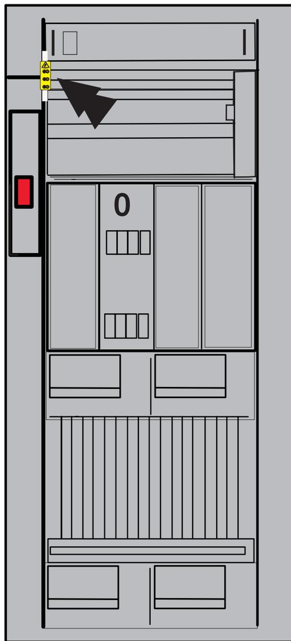
導入済み装置の正しい場所に、「>200V」ラベルが読み取り可能な状態で付けられていることを確認します。
