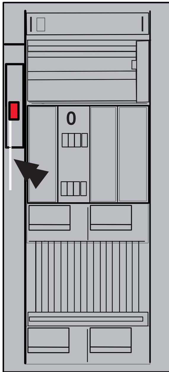
導入済み装置の正しい場所に、「>240VA」ラベルが読み取り可能な状態で付けられていることを確認します。
